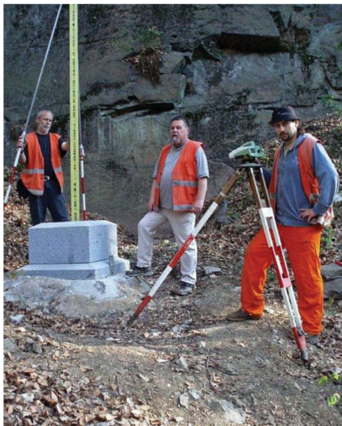
Kontrolní zaměření základního nivelačního bodu Chrastava
