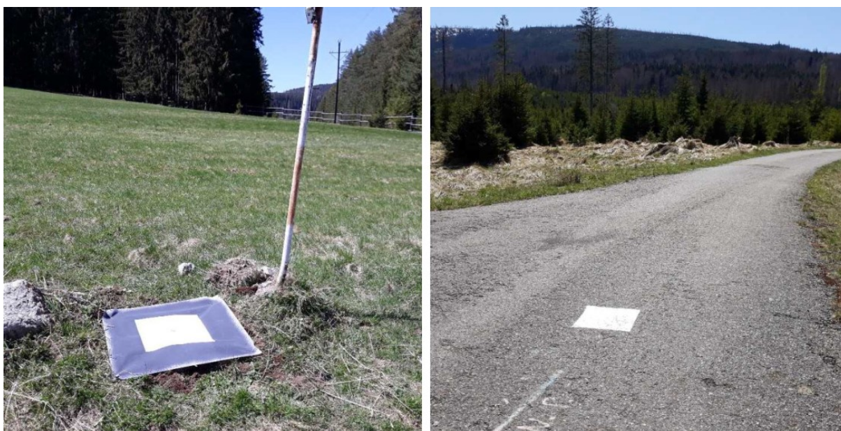
Obr. 6: Ukázka signalizace vřícovacích bodů v roce 2021 a 2022
